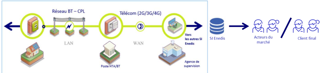
Schéma représentatif de la chaîne de transmission des données de mesure Linky
